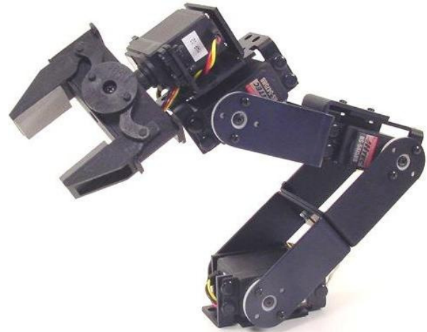
Een robotarm met 5 servo's
